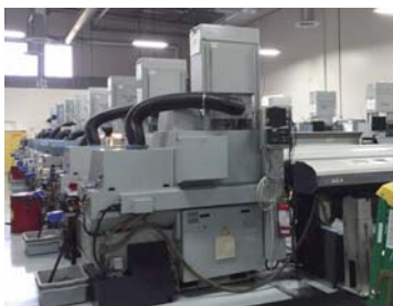
最新のコンピューター制御による旋盤機が何十台も並んでいた。
