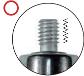
メクトロン社製の純正インサートチップを使用している正常ネジ山。
